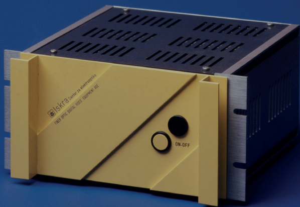
Ohišje in moduli VAE-naprave za prenos TV-signala po optičnem vlaknu, 1983-1984, oblikovala Janja Lap, izdelano v Iskri Elektrooptiki
