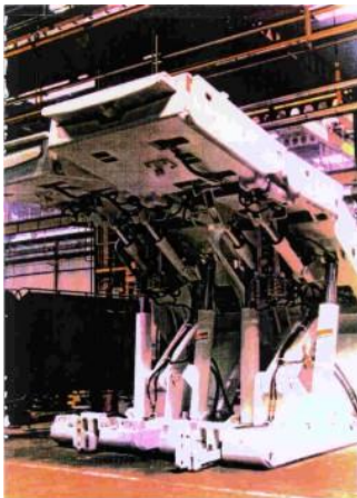
Slika 29. Sekcija hidravličnega podporja (levo) [6]; podporje med obratovanjem (desno) [7].
