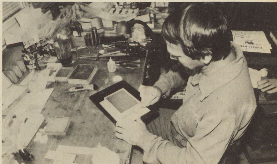
Pri Czech Master Kits pripravljajo epoksidni kalup za vakuumsko prešane pokrove kabin.
