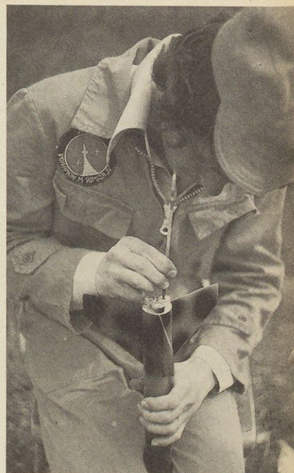
Pri vezavi motorjev v snop je treba s kosmi-čem vate vsak vžigalnik posebej dobro utrditi v šobe motorjev.
