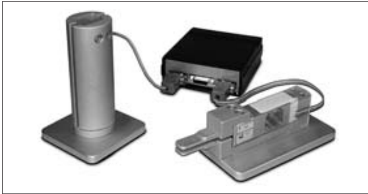
Slika 4. Naprava za merjenje sile prijema, ki jo priključimo na osebni računalnik. Omoogoča merjenje valjnega in stranskega prijema.
