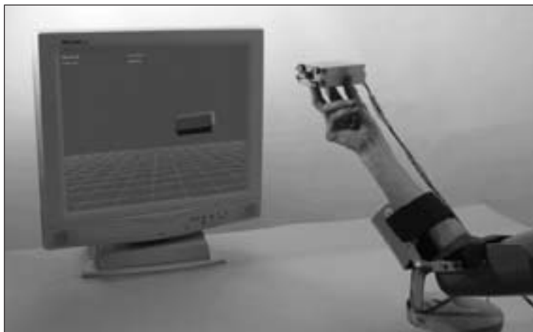
Slika 6. Eksperimentalno okolje za vrednotenje spretnosti prijema. Poskusna oseba hkrati opazuje resnični in navidezni predmet, ki ga mora zavrteti v želeno lego.
