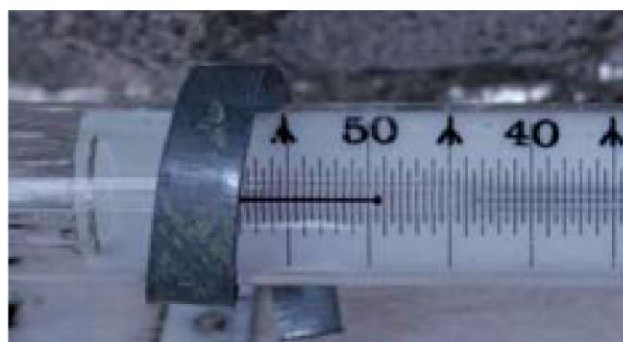
Slika 3: Minimalni termometer ob odčitavanju minimalne temperature 9. januarja 2009 zjutraj. Desni konec rjavega plovca kaže -49,1\text{ }^{\circ}\text{C} (foto: Andrej Trošt).
