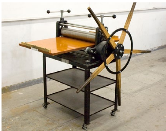
Slika 2a: Stiskalnica za visoki in globoki tisk (Musashino Art University, MAU Art & Design glossary, 2024)
