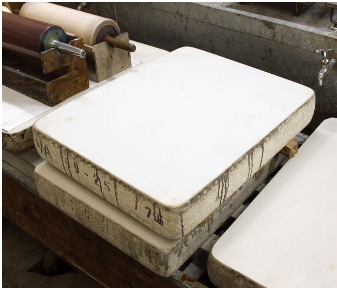
Slika 52: Litografski kamni in valji. Vir: MAU Art & Design Glossary, 2024
