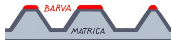
Slika 1: shematski prikaz preseka matrice visokega tiska (Dare Birsa, 2018)
