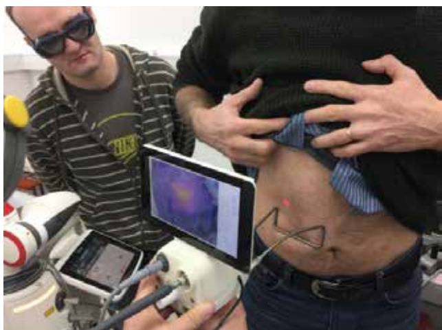
Slika 11 : Demonstracija delovanja termalnega nadzor-nega modula za laserske medicinske posege - ILOOP. Sistem uporablja termalno in barvno kamero za sprotni prikaz in analizo lasersko tretirane kože
