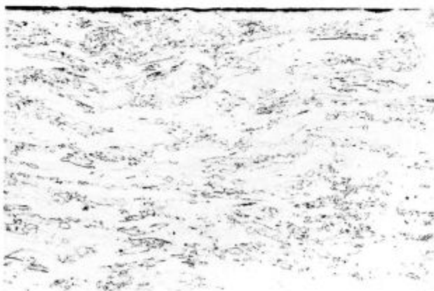
Slika 2: Mikrostruktura nerazogljčene neorientirane elektro pločevine po 15-minutnem žarjenju pri 625°C (100 x)
