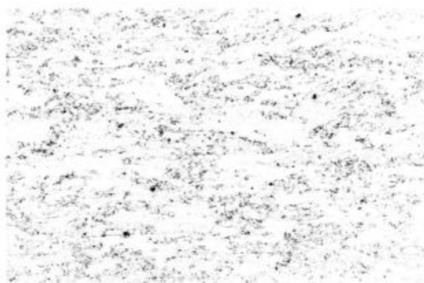
Slika 1: Mikrostruktura razogljčene neorientirane elektro pločevine po 35 minutah žarjenja pri 625°C (100 x)
