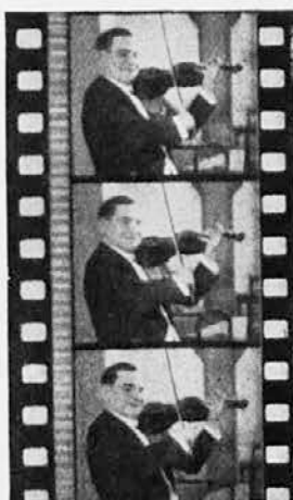
Slika 4. Del traku zvočnega filma v naravni velikosti. Na levi med preluknjanim robom in sliko je proga za reprodukcijo zvoka
