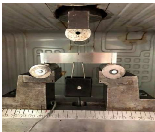
Slika 1. Merjenje lomne žilavosti s tri-točkovnim upogibnim preizkušancem (SENB).
