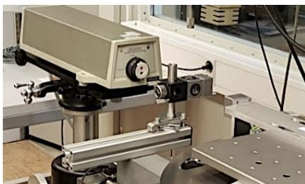
**Laser Interferometer HP 5528A Agilent USA**
