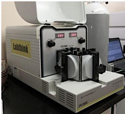
**PERME OX2/230 - OTR Labtechnik instrument**
