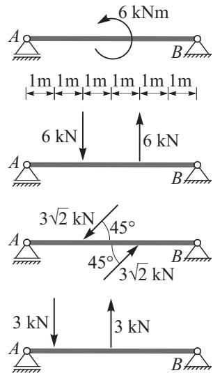
**Rešitev:** Izračunajmo reakcije ter določimo notranje sile za prvi referenčni primer. Na sliki prikazujemo predpostavljene reakcije  $A_z$ ,  $B_z$  in  $B_x$ .
