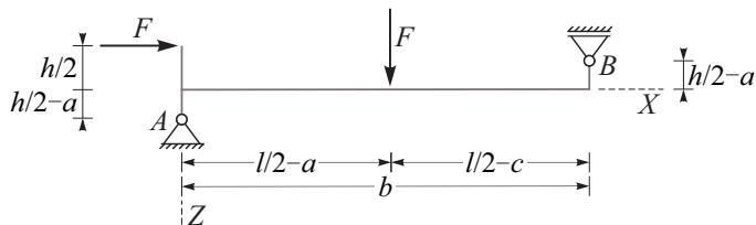
Reakcije v podporah  $A$  in  $B$  izračunamo iz ravnotežnih pogojev:
