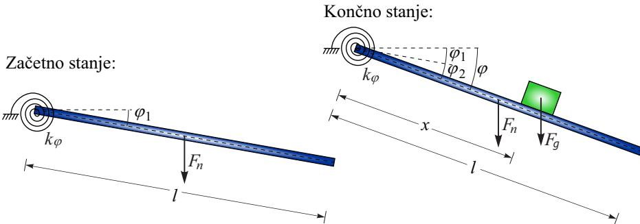
**Rešitev:** Določimo največji kot  $\varphi = \varphi_1 + \varphi_2$ , pri katerem klada še ne zdrsne po nosilcu. Napišemo ravnotežne pogoje v smeri nosilca in v smeri, pravokotno na nosilec. Vse sile, ki delujejo na klado, so prikazane na sliki.
