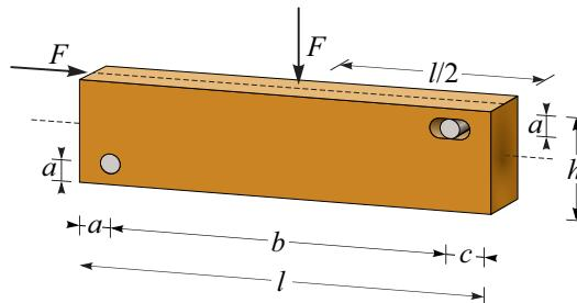
**Rešitev:** Zaradi načina vgradnje moznikov predpostavimo, da je podpora ob mozniku na levi nepomična, podpora ob mozniku na desni strani pa drsna. Tako podpori kot vodoravna sila  $F$  ne ležita v osi nosilca, zato linijski model nosilca ob predpostavki, da je tog, narišemo tako, kot kaže spodnja slika.
