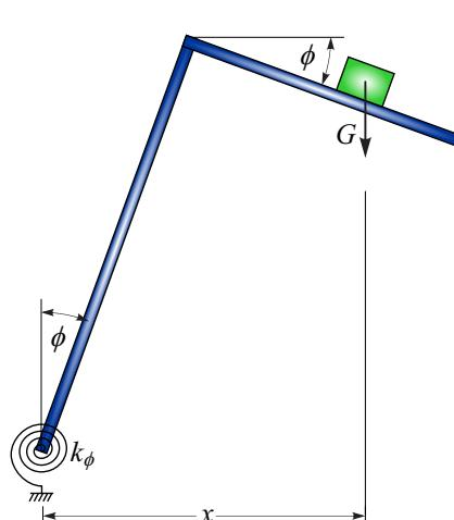
**Rešitev:** Iz ravnotežnih pogojev za klado, ki jo ločimo od nosilca, lahko določimo mejni kot, ko klada še ne zdrsnje z nosilca:
