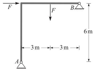
**Rešitev:** Ker je reakcija v podpori  $A$  navpična, upogibnih momentov v stebru ni. Upogibni moment je od nič različen le v nosilcu in je največji na mestu delovanja navpične sile. Zato je naš prvi cilj, da izračunamo ta upogibni moment. Še prej določimo reakcije v podporah, te so:
