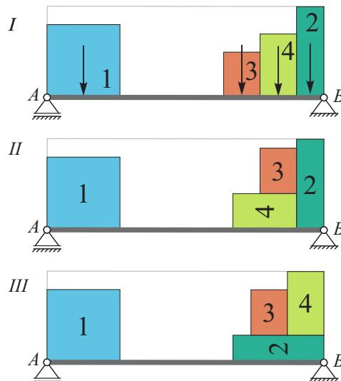
Pri določitvi reakcije v podpori A in upogibnega momenta na sredini nosilca lahko učinek zaboja nadomestimo s točkovno silo. Pri razporeditvi zabojev I izračunamo reakcijo  $A_z$  in upogibni moment  $M_y$  z enačbama
