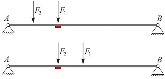
Pri prvi legi vozila na mostu izračunamo reakcijo  $B_Z$  izračunamo iz momentnega ravnotežnega pogoja glede na točko  $A$  in v nadaljevanju še upogibni moment  $M_1$ :
