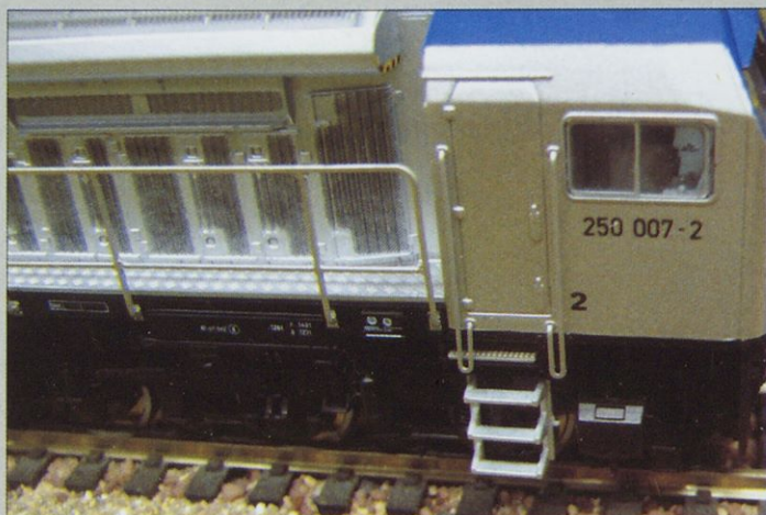
Ograje in držala ob vratih na kabini so izdelani iz kovine s fotojedkanjem. Druga držala na kabini so iz 0,4 mm debele žice, kar je zelo blizu realnosti.
