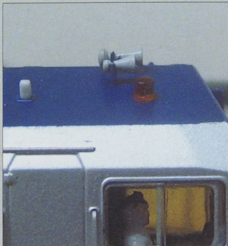
Delovanje utripajoče rumene delovne luči vklopimo na digitalni centrali s tipko F5. Utripajoča luč bo delovala tudi v analogno vodenem sistemu, če prek digitalne centrale ali ESU-jevega LokProgramerja na dekoderju CV13 to funkcijo nastavimo na položaj 16.
