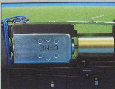
Sodoben petpolni motor z velikim vztrajnikom je vgrajen na sredini podvozja, od koder se prek kardana pogon prenaša na oba trionska podstavna vozička.
