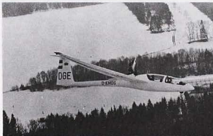
DG-500 ELAN (dvosed z lastnim motorjem)
