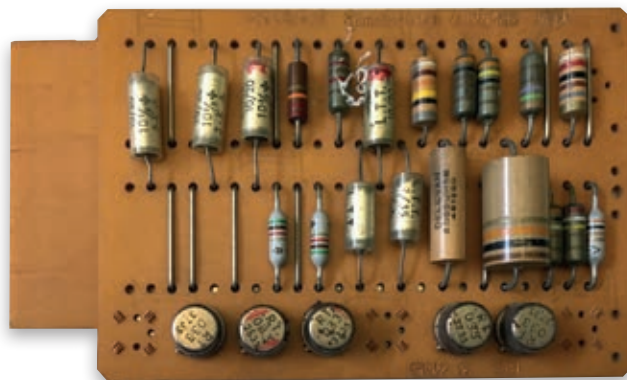
◀ Kartica za IBM 1401 in vložišče za kartice
