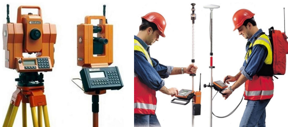
Slika 3: Avtomatizirani univerzalni tahimeter Geodimeter System 4000 s kontrolno enoto RPU 4000 za daljinsko upravljanje (objavljeno z dovoljenjem Shelly Cox, xyHt Magazine) in uporaba kontrolne enote Spectra Precision Geodat Win za terestrična in satelitska merjenja (Spectra Precision, 1999).
