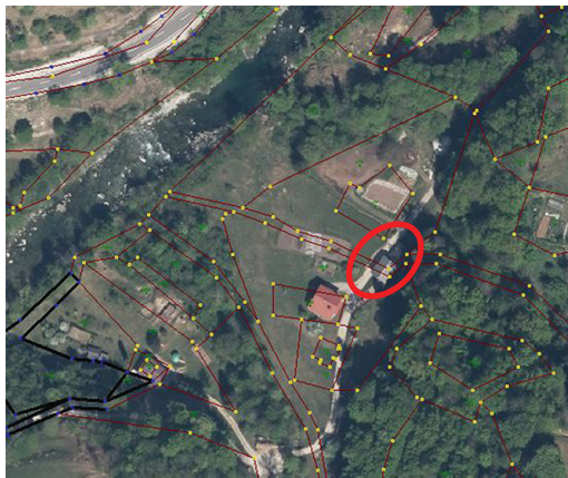
Slika 6: Vklup zemljišča pod stavbo z neposredno uporabo koordinat bi povzročil topološke napake na sloju ZKN.
