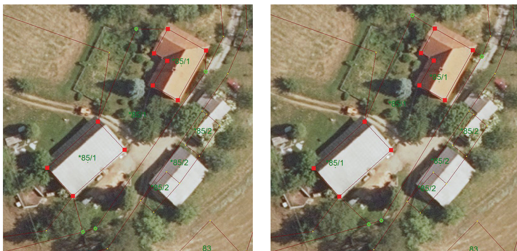
Sliki 3 in 4: Neustrezen vklop podatkov geodetske storitve na sloj ZKN brez prilagoditve okolice (levo) in kakovosten vklop podatkov s prilagojeno okolico (desno). ZK-točke, ki so predmet geodetske storitve, so prikazane z rdečimi kvadrati. ZK-točke, ki imajo spremenjene koordinate zaradi prilagoditve okolice, pa so prikazane z zelenimi krogi.
