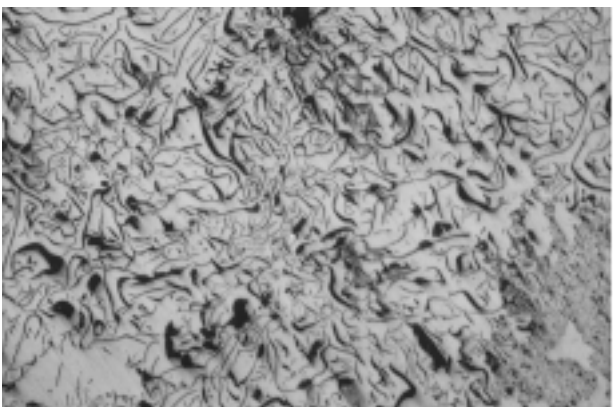
Slika 10: Grafit v nemodificirani sivi litini z lamelnim grafitom (L36), S_C = 0,99 ; a) polirano, povečava 100-krat, lamelni in rahlo vermikularni grafit, b) jedkano z nitalom, povečava 100-krat, mikrostruktura matrice sive litine z lamelnim grafitom, ob grafitu ferit in perlit
