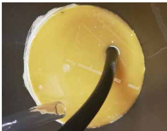
Slika 6 : Spenjena hidraulična kapljevina po zagonu dozirne črpalke.
