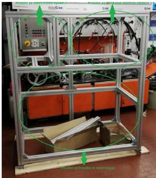
Slika 3 : Aluminijasta konstrukcija preizkuševališča (1500 mm x 1680 mm x 800 mm)
