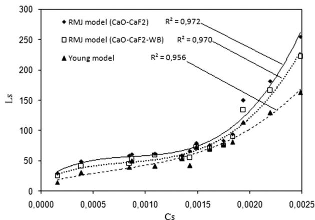
**Figure 6:** Effect of  $C_s$  on sulphur distribution**Slika 6:** Vpliv  $C_s$  na razporeditev žvepla
