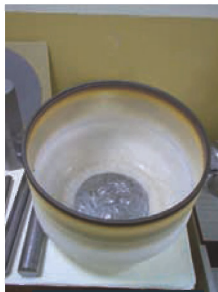
Keramična posoda za topljenje silicija za laboratorijske namene
