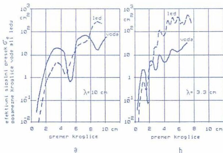
Slika 4. Sipalni presek kroglice ledu je odvisen od velikosti in od valovne dolžine elektromagnetnega valovanja.
