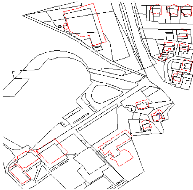
Slika 6.13: Strehe stavb (rdeče) kot dodatni element v zemljiškokatastrskem načrtu (črno) v panoramskem pogledu.
