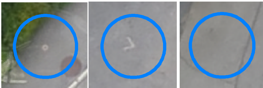
Slika 6.7: Od prejšnjega snemanja vidna signalizacija jeklenih klinov s sprejem (levo in sredina) in nesignaliziran jekleni klin, ki ne omogoča zajema (desno) (ortofoto: Geavis d. o. o.).
