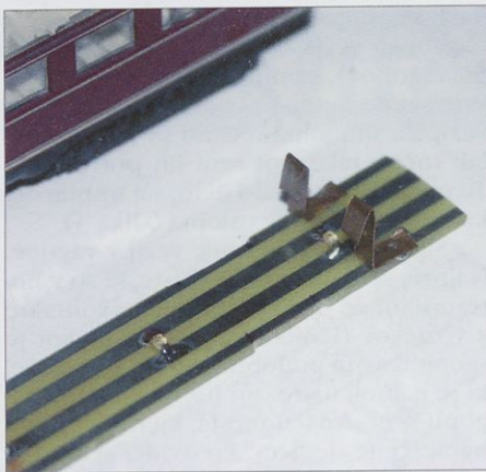
Slika 7.1. Z navadno bakreno folijo ustvarimo odjemnik z vagona za napajanje našega vezja.
