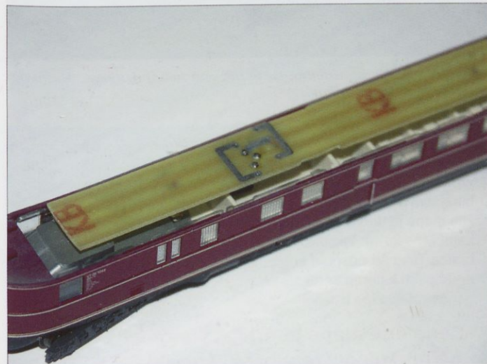
Slika 6. Tu je tranzistor skrit v prostoru za sprevodnika oziroma v kuhinji.
