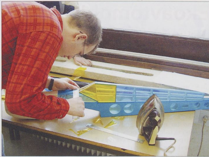
Prekrivanje konstrukcije s folijo
