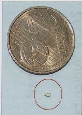
Slika 1.1. LED-dioda v SMD izvedbi standardne velikosti (SMD, oblika ohišja 0603)
