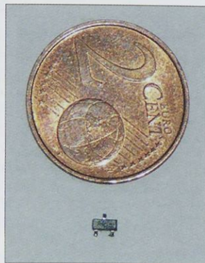
Slika 1.3. Dvojna dioda v obliki SMD (SOT-23). Elementa sta enake oblike, a imata zelo različne lastnosti.
