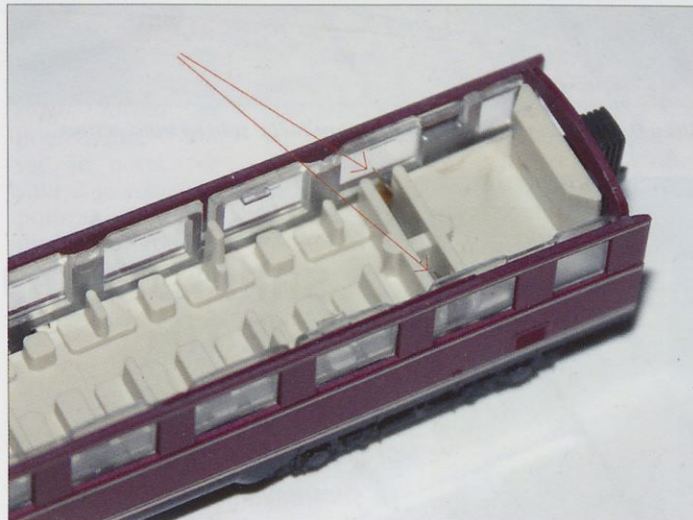
Slika 7. Vagon je že tovarniško opremljen s kontakti s tira, kar vemo po tem, da je na sprednjem delu vagona žarnica.
