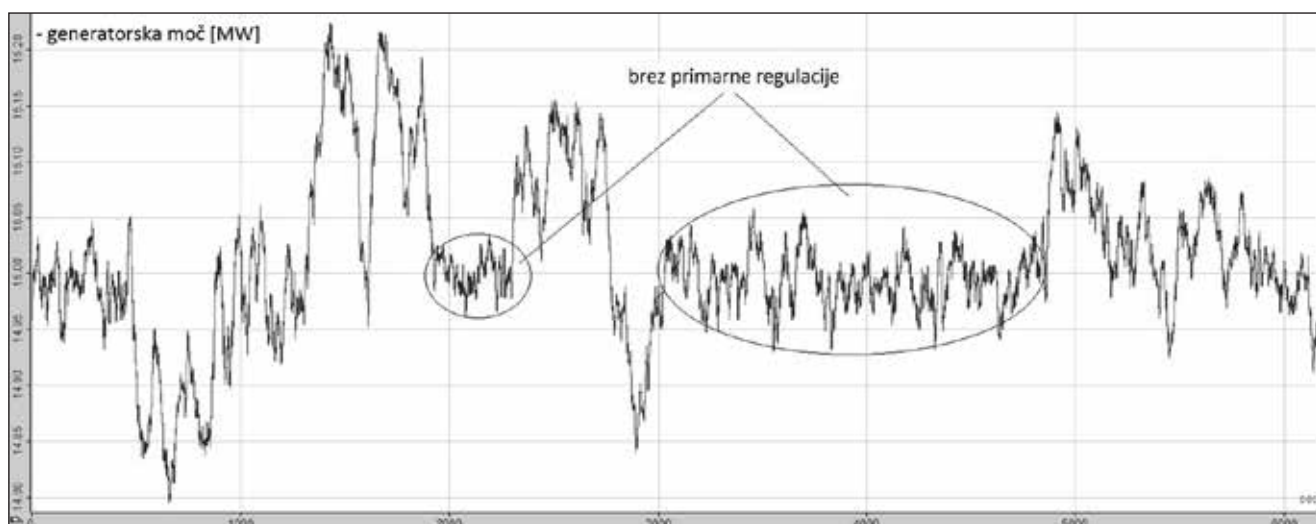
Slika 4. Prikaz nihanja delovne moči generatorja v primeru delovanja primarne regulacije in v primeru neaktivnosti
