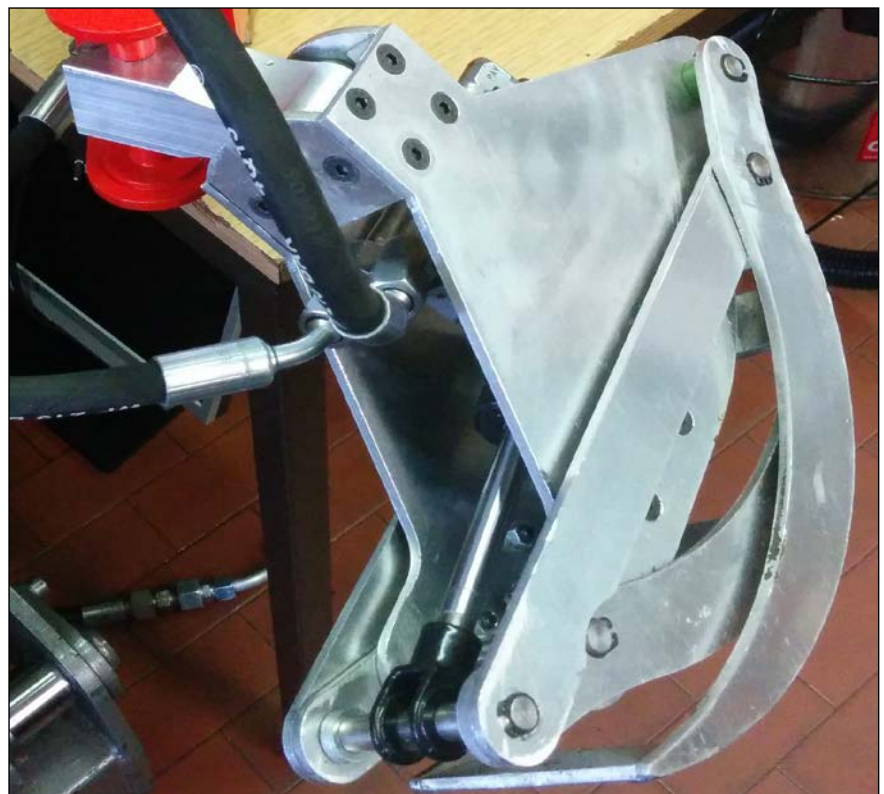
Slika 12. Izdelane klešče v zaprtem stanju 2
