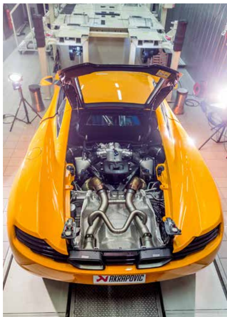
» McLaren MP4-12C z montiranim Akrapovič izpušnim sistemom iz titana
