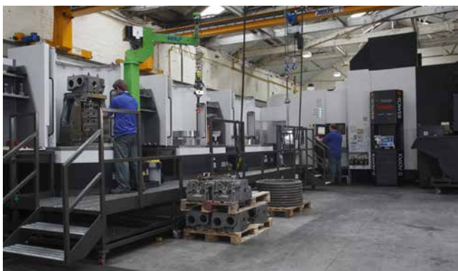
» Fleksibilni proizvodni sistem na stroju INTEGREGX e-1060V II
