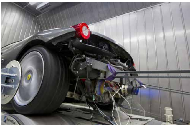
» Primer meritev na prototipnem izpušnem sistemu (Ferrari 458 Italia)
