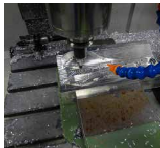
» Slika 2: Izdelava gravure na rezkalnem stroju
