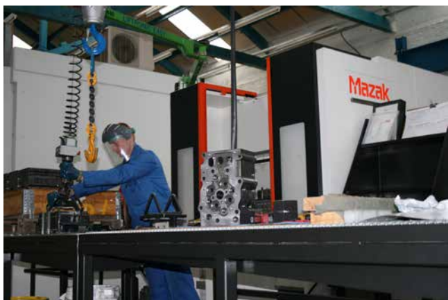
» Upravljalnik odstranjuje glavo bata iz enega od horizontalnih centrov NEXUS 6000-II v podjetju John Hyde Engineering.
