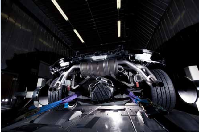
» Primer montiranega Akrapovič izpušnega sistema iz titana (Audi R8) na dinamometru.
