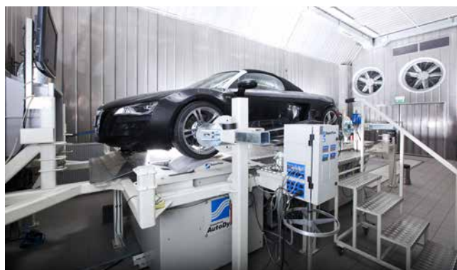
» Sodoben dinamometer, na katerem potekajo meritve moči. Na sliki Audi R8 V10
