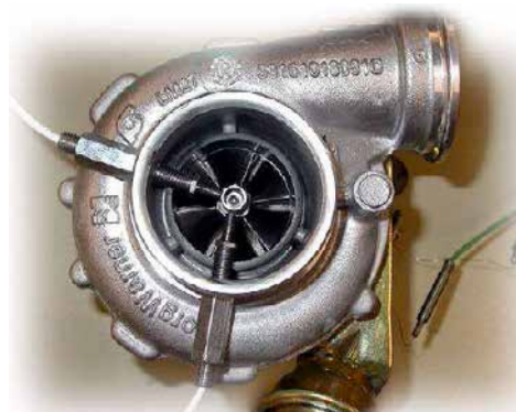
» Slika 7: Merjenje oscilacij gredi z dvema pravokotno nameščenima senzorjema
