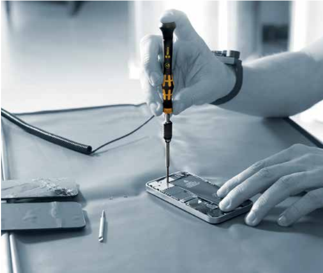
» Dobavitelji pametnih telefonov priporočajo pritezni moment 3,5 Ncm. Pri tej vrednosti občutimo popuščanje in zaslišimo jasen zvok.
