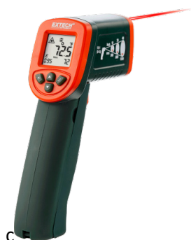
Slika 1.9: Eno valovni sevalni termometer z zaslonko. Odprtina zaslonke skupaj z aktivnim poljem detektorja določa vidni kot termometra in končno velikost merilne površine glede na oddaljenost od merjenca.
