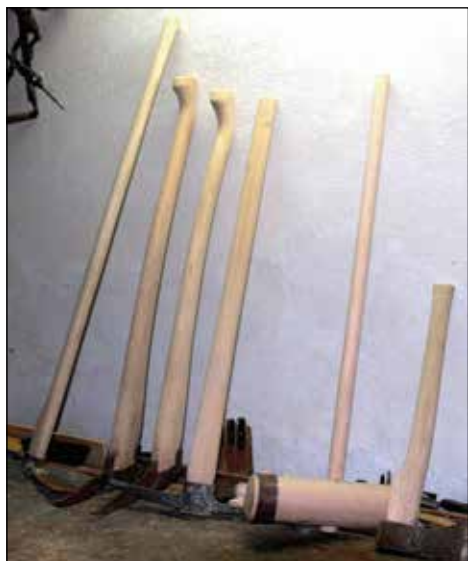
Novi leseni ročajji za orodje, izdelani v kolarski delavnici Keržarjevih v Železnikih. Foto: Anton Sedej
