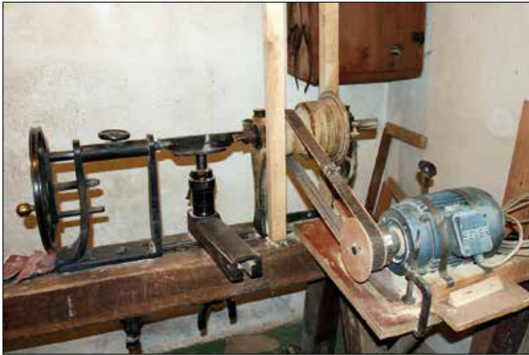
Kombinirani stroj za struženje, vrtnanje in žaganje, ki ga je izdelal Janez Keržar s pomočjo Matija Žumra.
