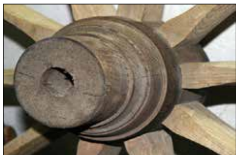
Detajl kolesa s pestom in špicami, izdelano in shranjeno pri družini Keržar v Železnikih. Foto: Anton Sedej
