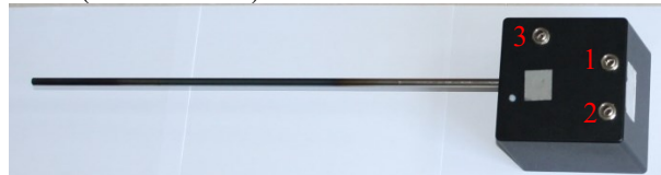
Slika 3: Slika izdelanega ojačevalnika. Na sliki sta označena oba izhoda (1,2) in vhod (3) za kalibracijski signal.
