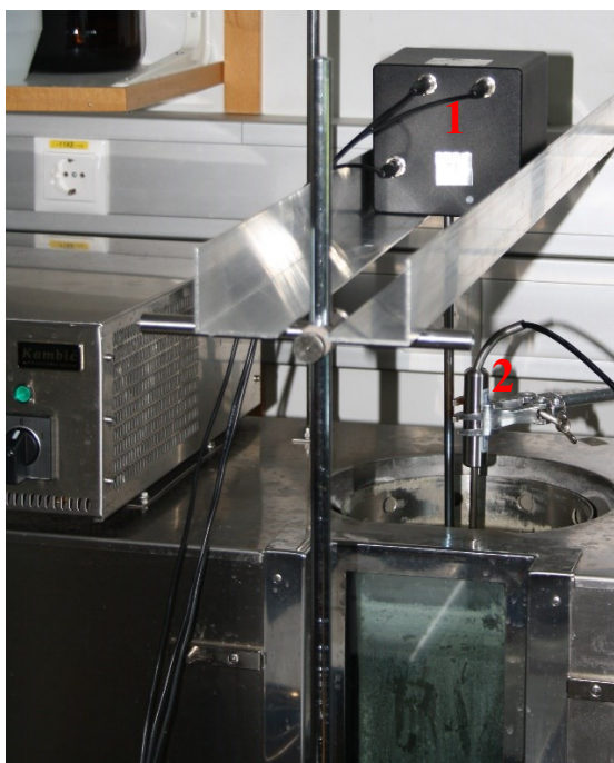
Slika 5: Postavitev šumnega termometra (1) in referenčnega termometra (2) v vodni kopeli.
