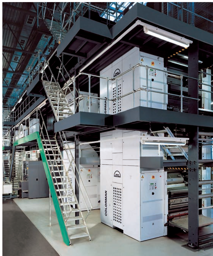
Nova ofsetna rotacija v Delu Colorman ima štiri satelitne enote v dveh tiskovnih stolpih, zato zmore tiskati vse strani časopisa v štirih barvah.
