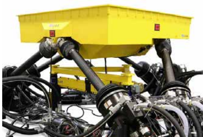
Slika 7 : Hidravlična simulacijska ploščad 353.50 (tloris 2500 mm x 2500 mm) [8]
