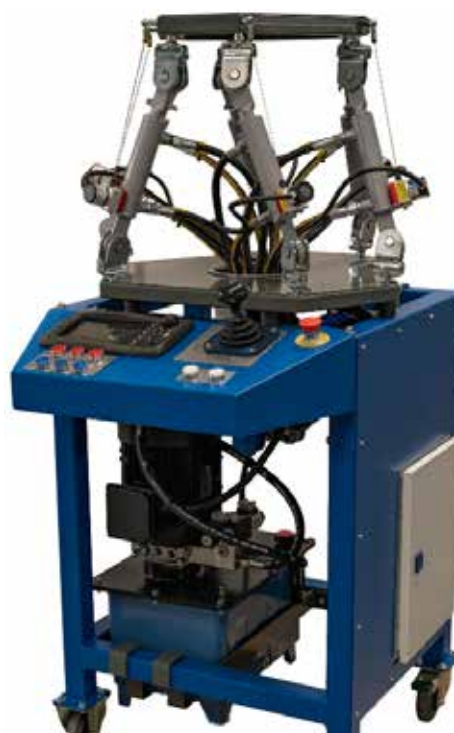
Slika 11 : Obstoječa manjša prototipna hidravlična Stewartova ploščad (685 mm x 844 mm x 1505 mm) [10, 11]
