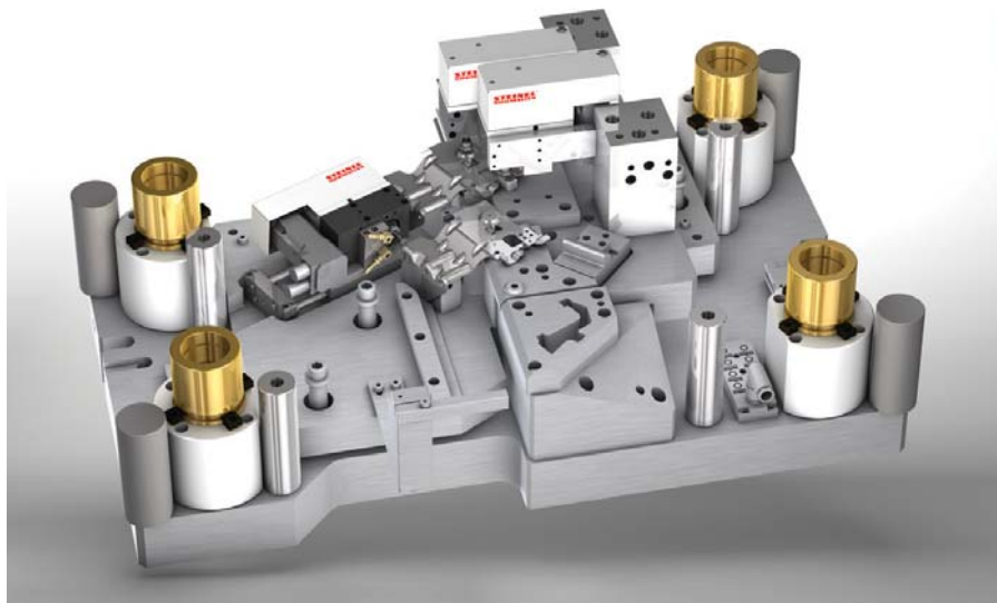
Slika 3: Integracija več multifunkcijskih enot, ki jih poganja servomotor (SME), v enem orodju.
