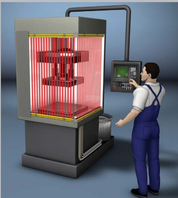
Velika stopnja dostopnosti s stalnimi kaskadnimi svetlobnimi zavesami SOLID-4E v 90-stopinjski L-različici
