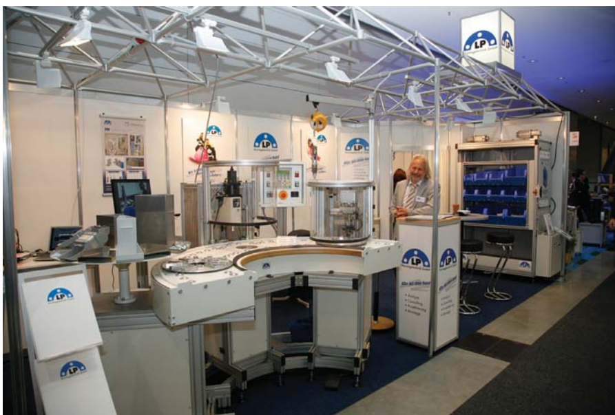
Tok materiala po načelu kos za kosom z nosilcem za več izdelkov – v ozadju omara z dvignimi policami za prilagoditev višine za jemanje iz zabojev na policah
