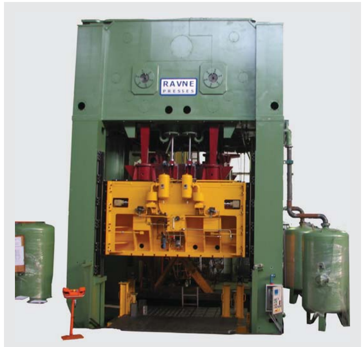
Primer dvo-akcijske stiskalnice Ravne »DA630/400-36-25« izdelane za podjetje MAZ, v Minsku, Belorusija. Podobno stiskalnico so v Litostroju Ravne izdelali tudi za Revoz, Novo mesto
