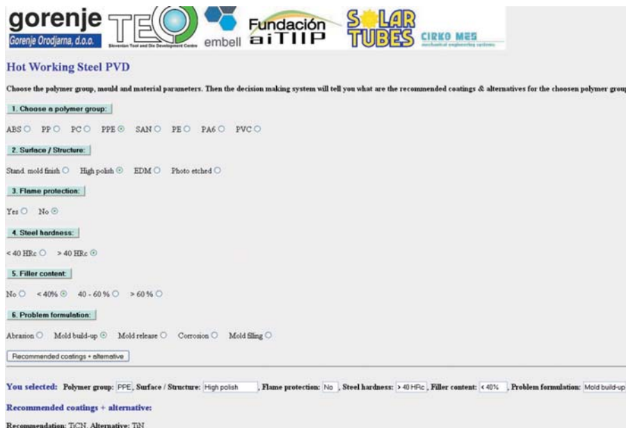
Slika 8: Prikaz aplikacije DMS – vnos zahtev in izpis priporočene prevleke ter alternative
