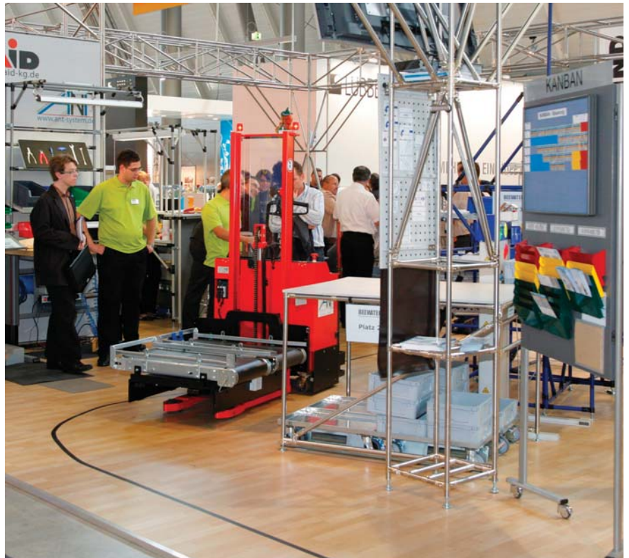
Samodejno vodeni viličar s transportnim sistemom za dve paleti ali zaboja
