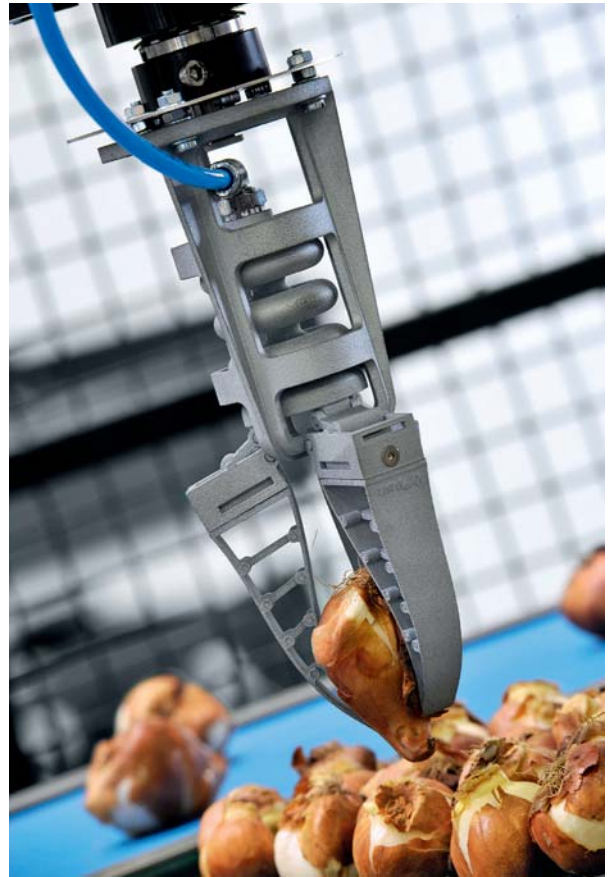
Učinkovito prebiranje rožnih čebulic glede na velikost in kakovost (foto: Festo)
