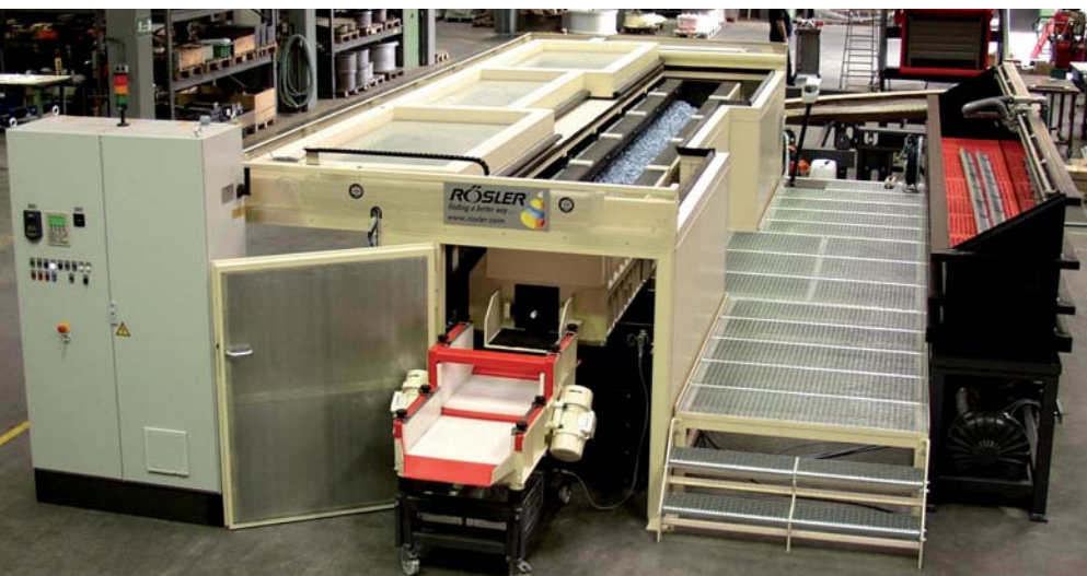
Drsnemu zglajevanju in čiščenju nosilnih elementov v letalski industriji je namenjen koritasti vibrator z učinkovito protihrupno zaščito. (Foto: Rösler Oberflächentechnik GmbH)
