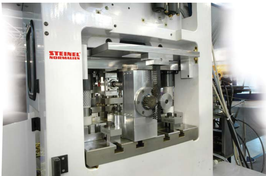
Steinel mehanske navojne enote (SMG) in multifunkcijske enote, poganjane preko servomotorja (SME) se dajo vgraditi v štančne procese in v procese preoblikovanja.
