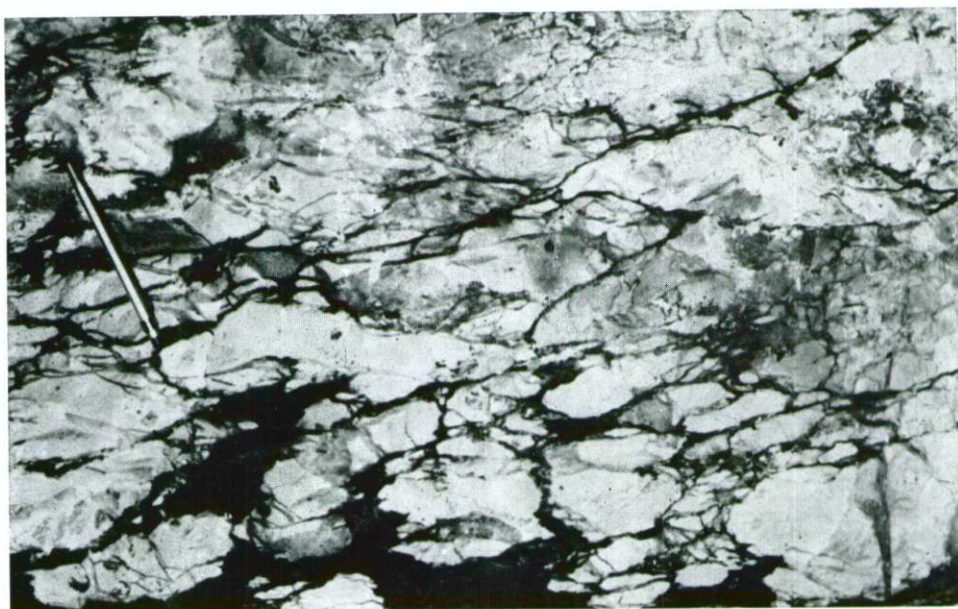
Sl. 5. Žilice sadre (sivo) v anhidritu (belo) na obrobju sulfatne leče. Rudišče Ljubevč Fig. 5. Gypsum veinlets (gray) crossing anhydrite (white) on the margin of the sulphate lens. Ljubevč mine
