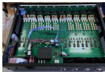
Slika 1: Od vrha slike navzdol: čelna plošča, glavna plošča in vezje z mikrokontrolerjem
