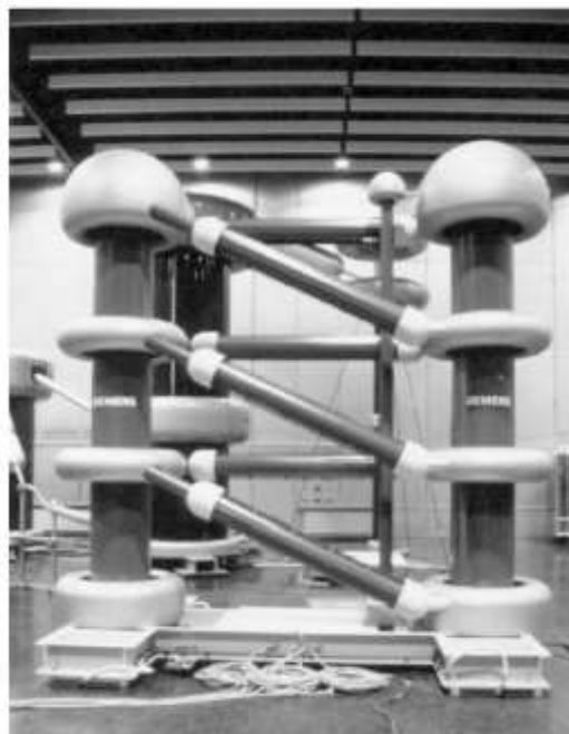
Slika 19-2: Levo: kaskadno vezje za zvišanje napetosti, tipična uporaba do 200 kV. Desno: Cockcroft-Waltonov CD generator na ETH (Švica) 900kV/10 MA.
