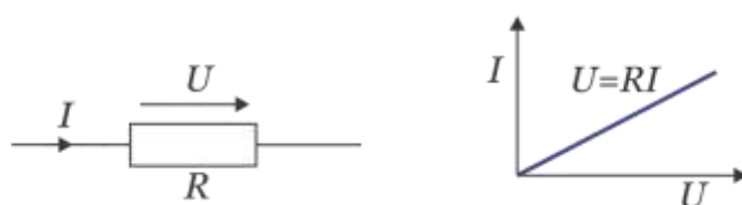
Slika 22-3: Levo: tok in napetost na uporu; Desno: grafično prikazana karakteristika upora.
