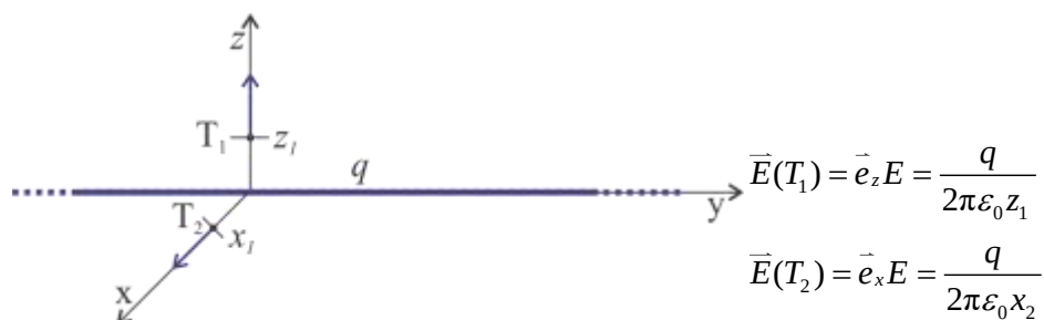
Slika 6-5: Primer določitve smeri polja naelektrene premice glede na umestitev v koordinatni sistem.
