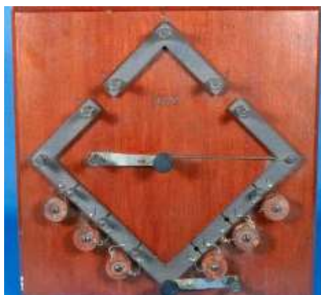
Slika: Ena osnovnih izvedenk Wheatstonovega mostiča, ki ga je sam imenoval diferencialni merilnik upornosti. (Hampden-Sydney College, Virginia), na desni »modernejša« izvedba. (Greenslade collection) Vir: Error! Reference source not found. in Error! Reference source not found..
