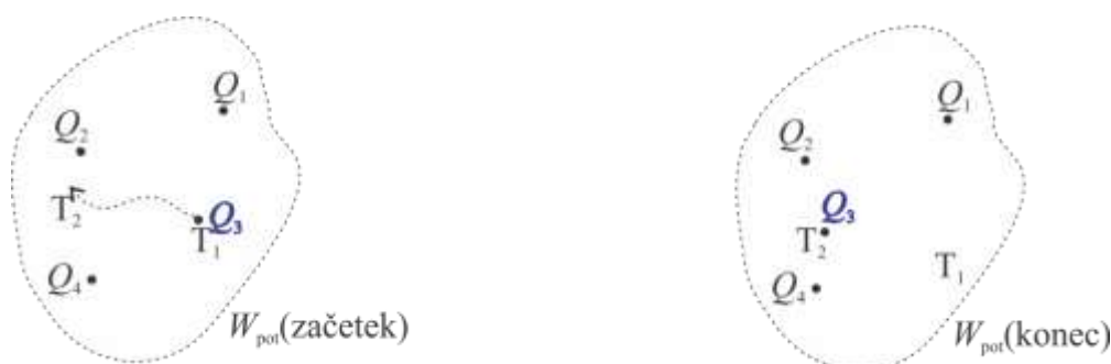
Slika 8-9: Delo električnih sil za premik naboja iz točke T_1 do točke T_2 je enako razliki potencialnih energij sistema pred premikom ( W_{\text{pot}}(\text{začetek}) ) in po premiku ( W_{\text{pot}}(\text{konec}) ).
