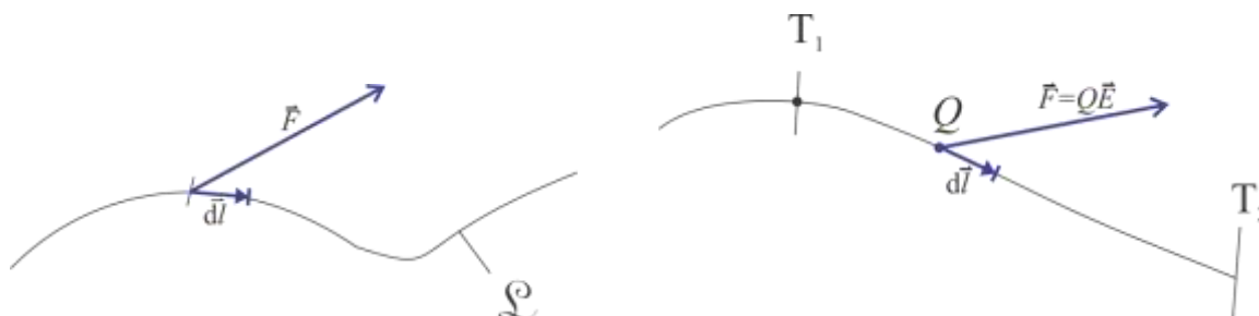
Slika 8-2: Levo: sila na poti = delo. Desno: delo električnih sil na poti od točke T_1 do T_2 .
