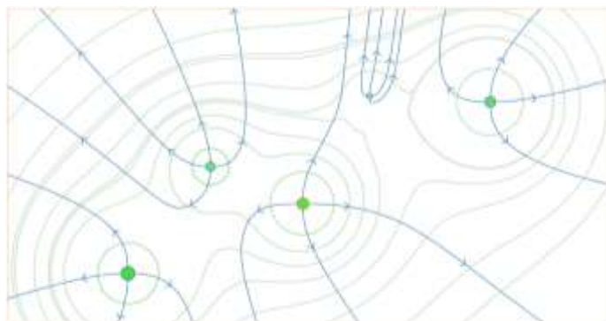
Slika 9-8: Simulacija porazdelitve ekvipotencialnih ploskev in silnic. Na spletni strani lahko premikate in dodajate naboje ter opazujete spremembe: http://tinyurl.com/equipot-lines . Dodaten komentar: ekvipotencialne ploskve se sicer pravilno izrisujejo, ni pa med sosednjimi enaka napetost, kar je sicer običaj pri risanju ekvipotencialnih ploskev, saj iz tega, kjer so bolj zgoščene razberemo področja z večjim električnim poljem.
