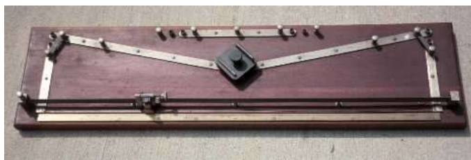
Slika: Kirchhoffov mostič temelji na gibljivem (drsnem) kontaktu in omogoča merjenje majhnih upornosti. (Vir: Error! Reference source not found. in Error! Reference source not found.)
