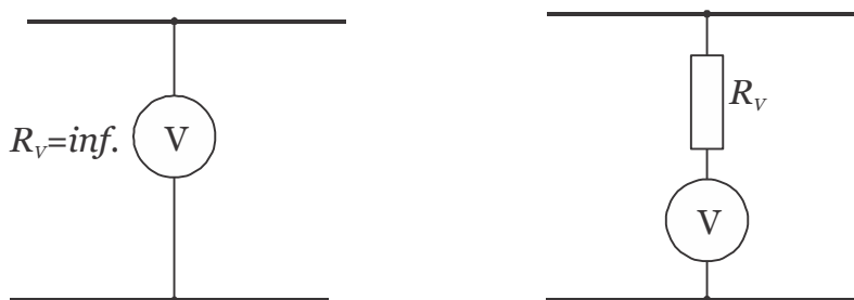
Slika 23-19: Voltmeter: priključitev, razlika med idealnim in realnim voltmetrom.
