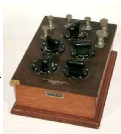
Slika: Ena osnovnih izvedenk Wheatstonovega mostiča, ki ga je sam imenoval diferencialni merilnik upornosti. (Hampden-Sydney College, Virginia), na desni »modernejša« izvedba. (Greenslade collection) Vir: Error! Reference source not found. in Error! Reference source not found..
