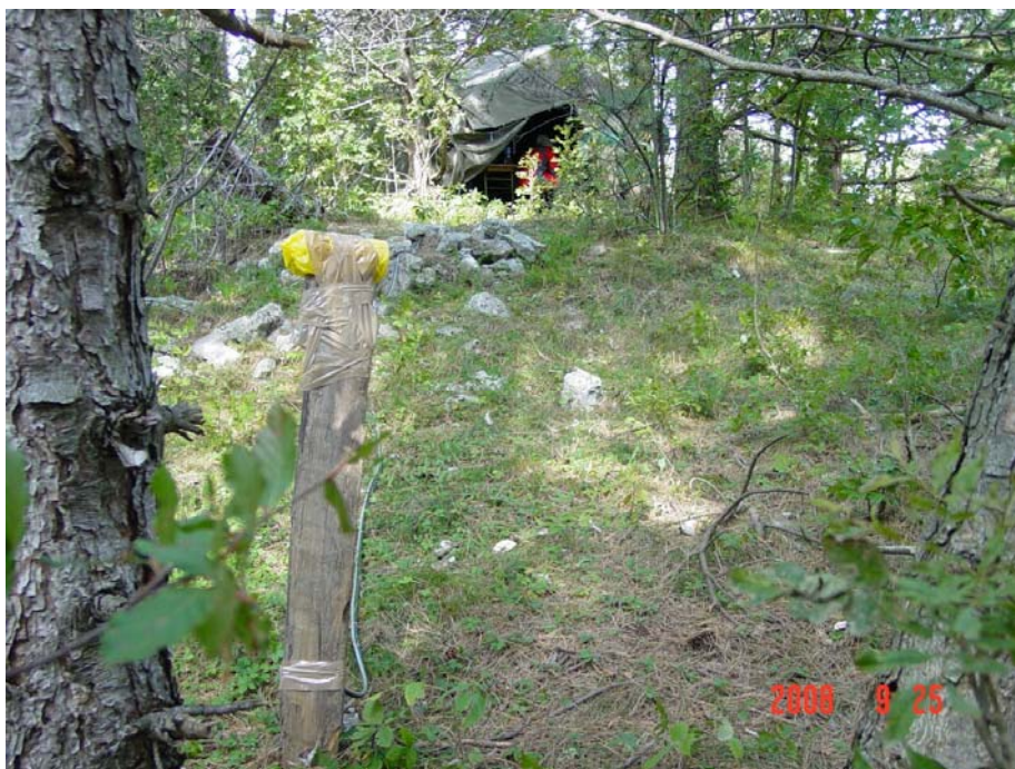
Slika 2: Postavljen in zaščitjen Overhauserjev protonski magnetometer GSM-19 (senzor)
