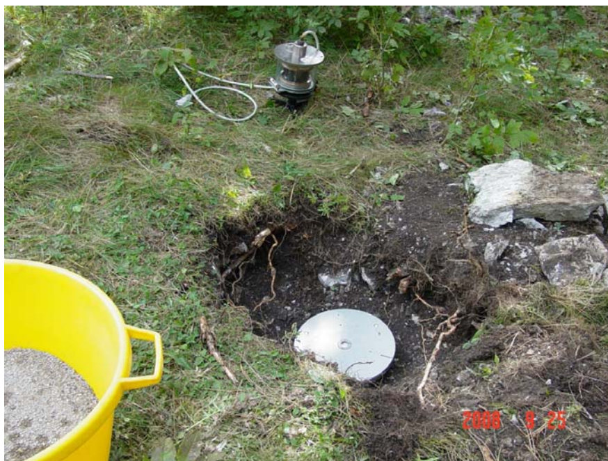
Slika 1: Položaj postavljanja trokomponentnega magnetometra MAGSON 11 (senzor)
