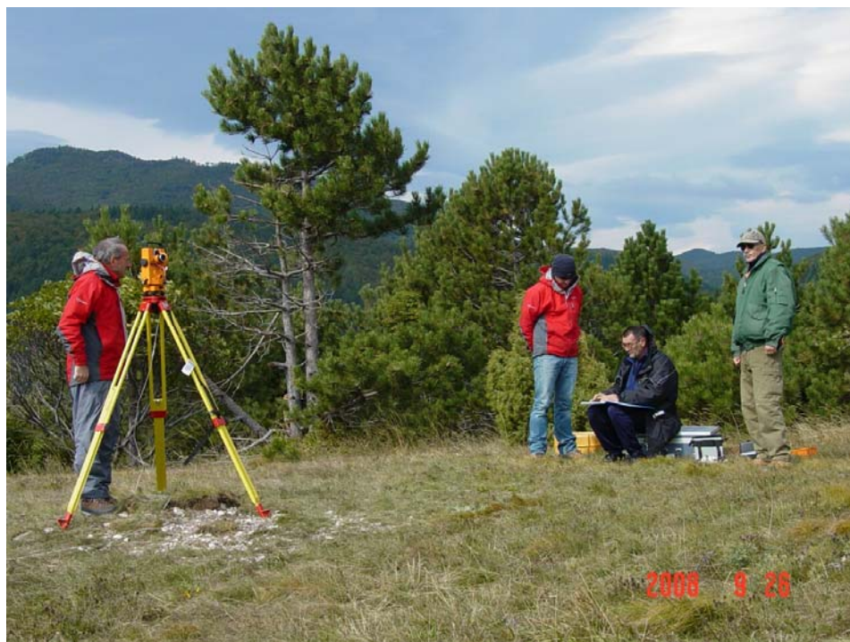
Slika 4: Absolutne meritve komponent D, I in F geomagnetnega polja na točki absolutnih merjenj na geomagnetni referenčni točki, na Predmeji
