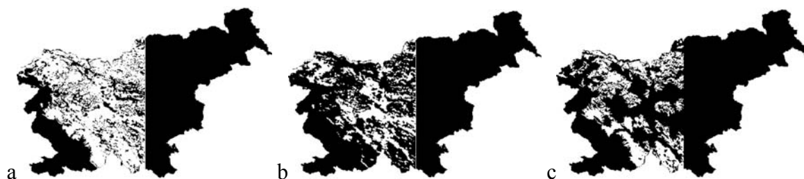
Slika 15 - Prikaz obdelave posnetkov: a ) območja snega glede na podatke s postaj, b) območja satelitsko zaznanega snega, c) razlika snežnih površin obeh posnetkov
