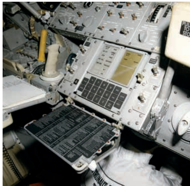
△ Računalnik, ki je sproti preračunaval gibanje vesoljskega plovila, je imel vmesnik nameščen v osrčju nadzorne plošče. Velikost tipk je bila prilagojena rabi z rokavicami, saj so bili astronauti oblečeni v vesoljske obleke.
