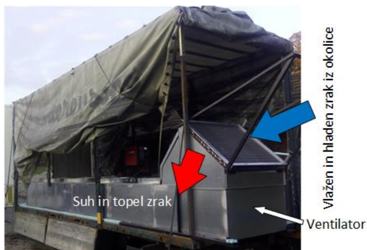
Slika 4: Sistem sušenja z uporabo toplotnega izmenjevalca – dogrevanje z biomaso ali s toploto iz bioplinarne (mobilna sušilnica) (foto Janez Benedičič).
