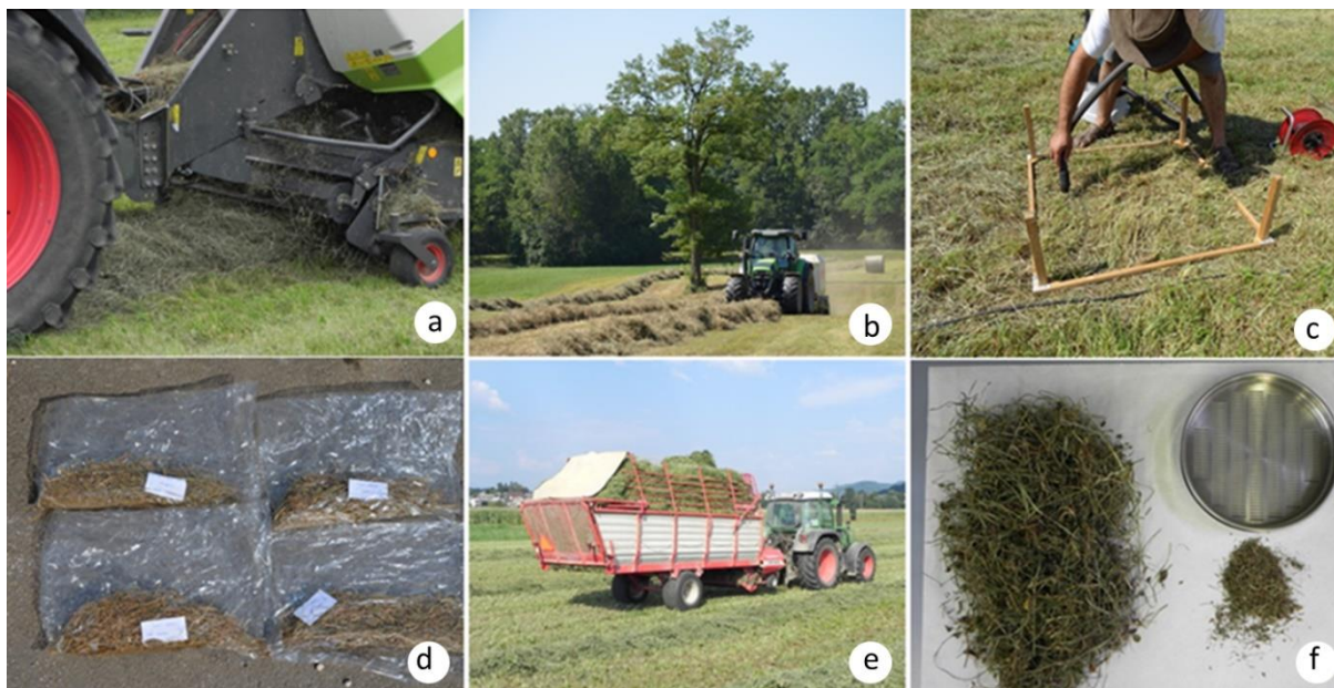
Slika 17: Izgube zaradi drobljenja pri spravilu suhe krme s balirko za velike kvadraste bale (Claas Quadrant 3200RC) (Slika a). Spravilo sena s balirko za valjaste bale (Claas Rollant 255) (Slika b). Zbiranje zdrobljene rastlinskega materiala s t.i. metodo sesalca (Slika c). Zbrani vzorci izgubljenega rastlinskega materiala (slika d). Spravilo lucerne s nakladalko (Pöttinger Laderprofi II) na sušilno napravo ki zajema zrak izpod tople strehe (Slika e). Ločevanje rastlinskih delcev in anorganskih primesi v zbranih vzorcih (Slika f).
