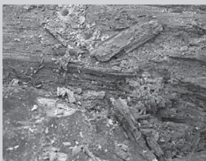
□ Slika 1. Les, napaden z lesnimi insekti (larvami)
