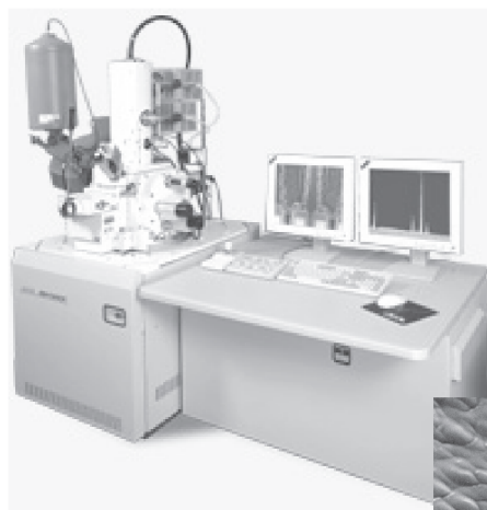
Elektronski mikroskop Jeol JSM-6500F opremljen z ED, WD in EBSD
