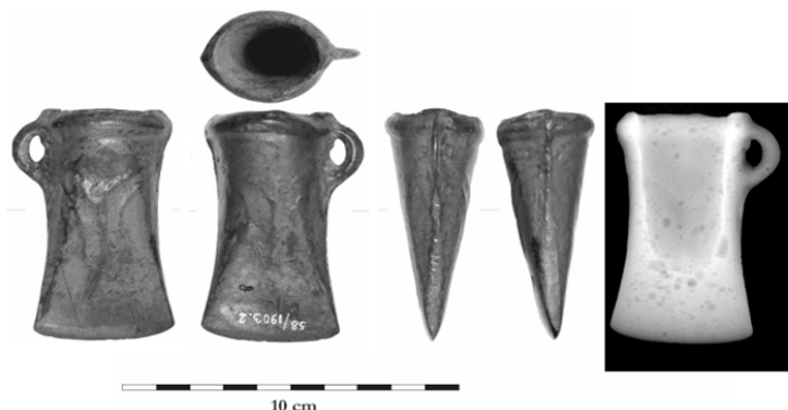
Slika 3. Geometrija artefakta in rezultat nevtronske radiografije.
