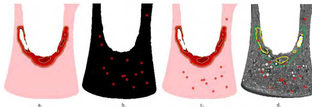
Slika 10. Simulirano in izmerjeno krčenje, 1100 °C (D2).
