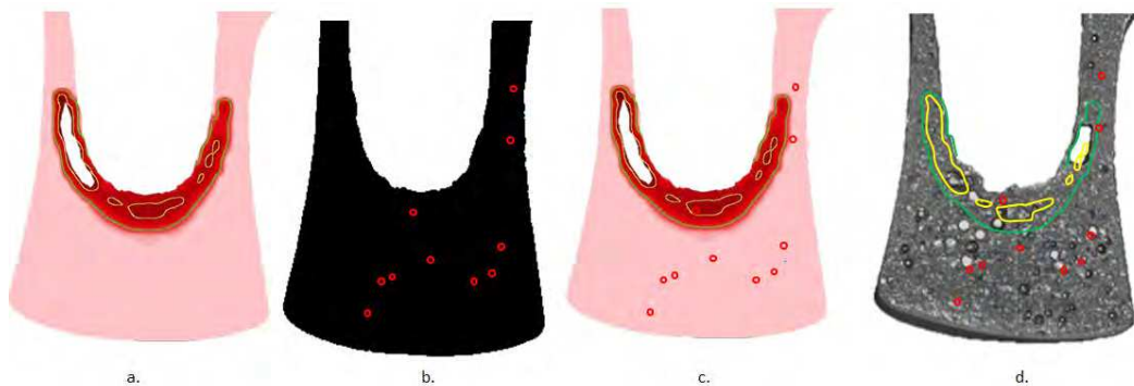
Slika 9. Simulirano in izmerjeno krčenje, 1015 °C (C1).
