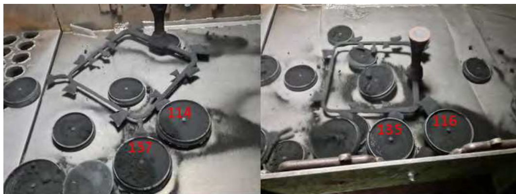
Slika 10. Neodlomljeni ulitki po prvi optimizaciji.
