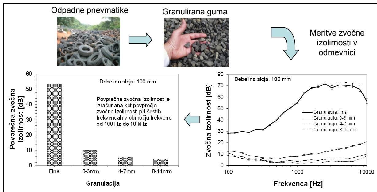
Elastomerni materiali izkazujejo dobre dušilne lastnosti v določenem frekvenčnem območju. Cilj projekta je bil razvoj kompozitnih materialov na osnovi granulirane gume, pridobljene iz odpadnih pnevmatik z izboljšanimi dušilnimi lastnostmi.
