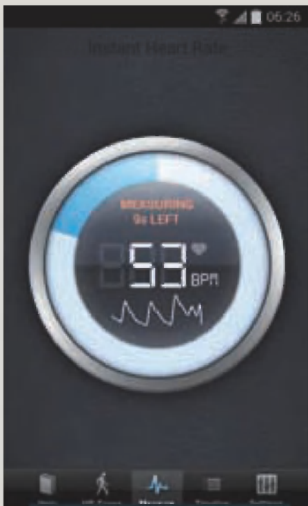
Mobilni merilec srčnega utripa deluje z analizo pretoka krvi v prstu, ki ga pritisnemo ob lečo kamere.
