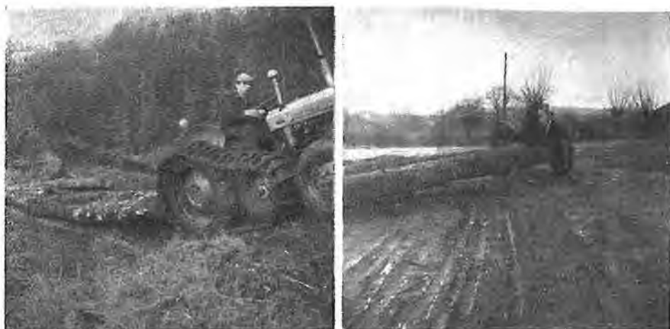
Slika 6. Levo: Vlačenje hlodov na »vlak«. Desno: Vlačenje dolgih hlodov. (Foto: A. Faganel)
