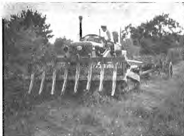
Traktor-goseničar od 120 KM z rastrelom spredaj in krožno brano zadaj (Haute Marne, orig.)
