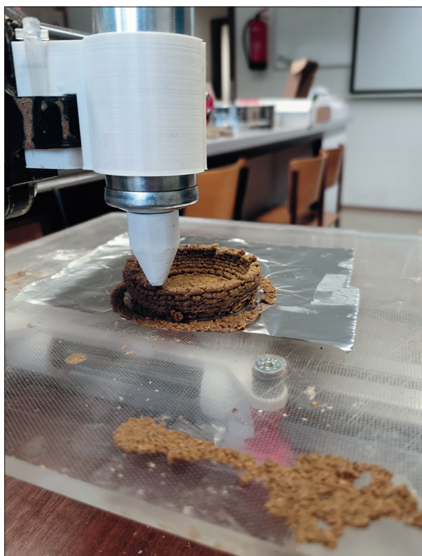
Slika 2. 3D tiskanje s pasto iz mešanice substrata, glivnega inokuluma in sredstva za želiranje, v tem primeru koruznega škroba (Foto: Blaž Žuran).
