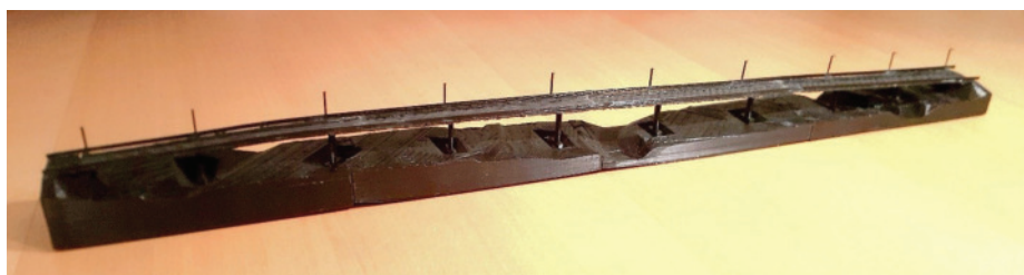
Slika 11 • Maketa nadvoza, natisnjena s 3D-tiskalnikom.
