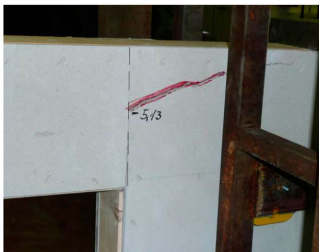
Slika 4.15: Prikaz razpoke na testnem vzorcu v skupini O1
