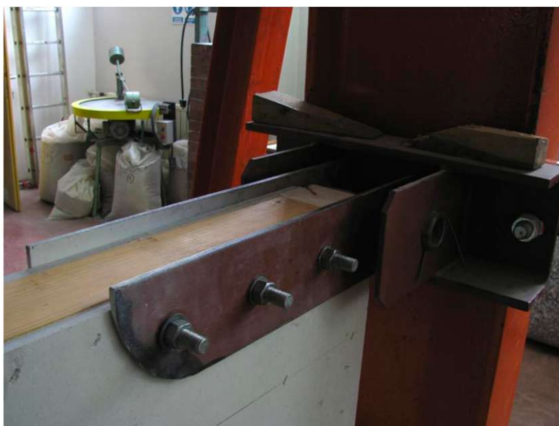
Slika 4.3: Detajl zgornje natezne podpore
