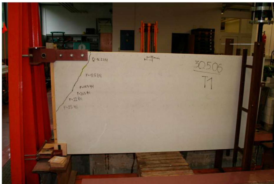
Slika 4.11: Eksperimentalna preiskava panelne stene brez odprtin, [7]
