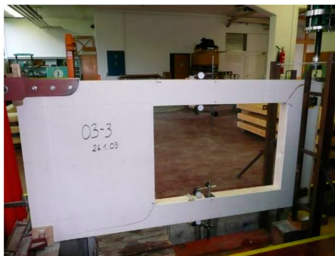
Slika 4.12: Prikaz porušitve MVP na vogalih odprtine
