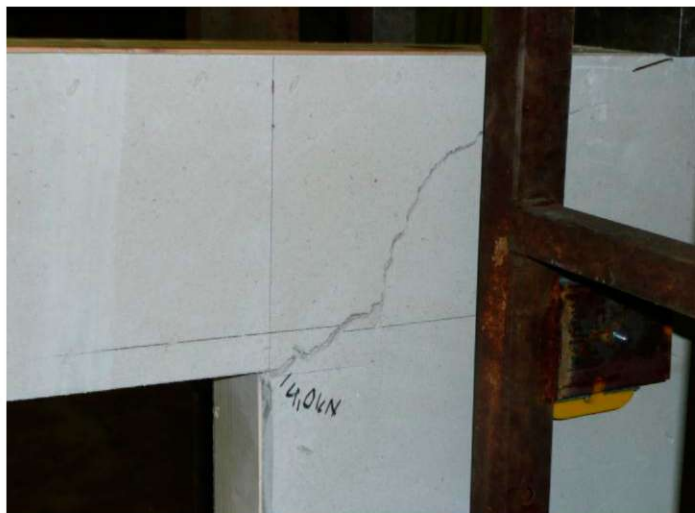
Slika 4.14: Prikaz razpoke na testnem vzorcu v skupini O3
