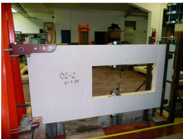
Slika 4.1: Eksperimentalna preiskava panelne stene z manjšo odprtino (O2)
