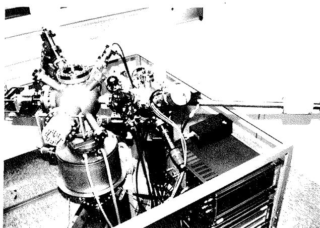
Slika 1: Visokovakuumski črpalni sistem z manipulatorjem, izdelek IEVT
