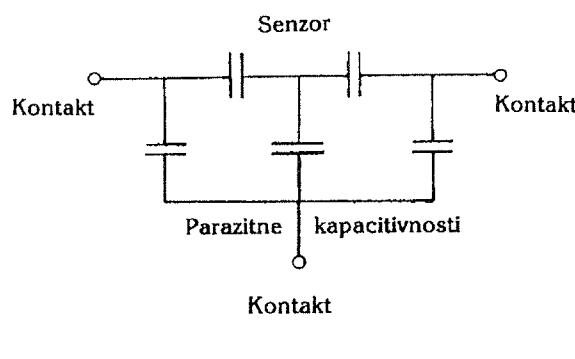
Slika 1: Shematski prikaz tankoplastnega kapacitivnega senzorja relativne vlažnosti zraka, 1a) električna shema senzorja
