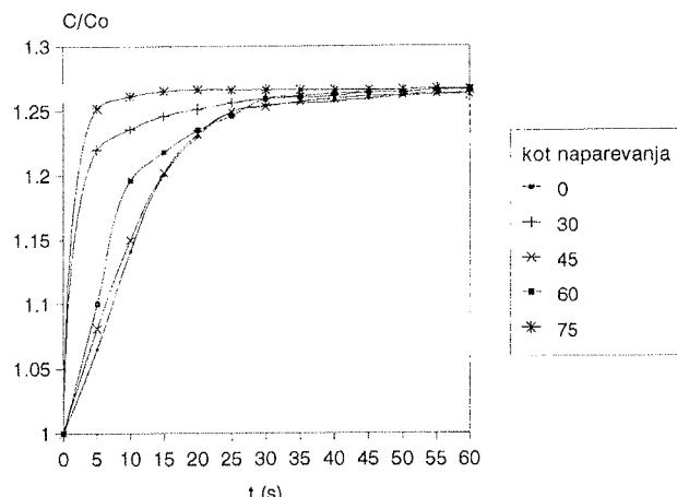
Slika 4: Prikaz odzivnega časa v odvisnosti od kota naparevanja zgornje elektrode
