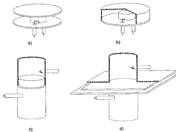
*Slika 1: Nekatere najpogosteje konfiguracije testnih merilnih sklopov za določevanje mikrovalovnih dielektričnih lastnosti: a) Courtney-evi dielekrometer [2,3,4], b) zaprti radialni dielekrometer [5], c) Cohn-ov dielekrometer [6] in d) merilni sklop za določevanje lastnosti substratov [7]*
