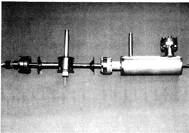
Slika 3: Kalibriran permeacijski leak, izdelek IEVT
