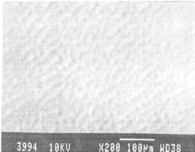
Slika 2: SEM posnetek površine polimera, povečava 200X.
