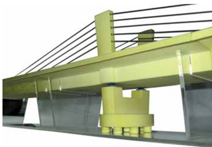
Slika 25 • Fotografija makete s prikazom jakenih žic, ki nadomeščajo zatege
